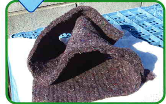
古布をリサイクルして厚さ1cmのフェルトを生成します
