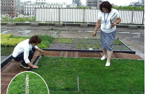
コンクリート上が45℃の時、フェルト層の中心は34℃でした
